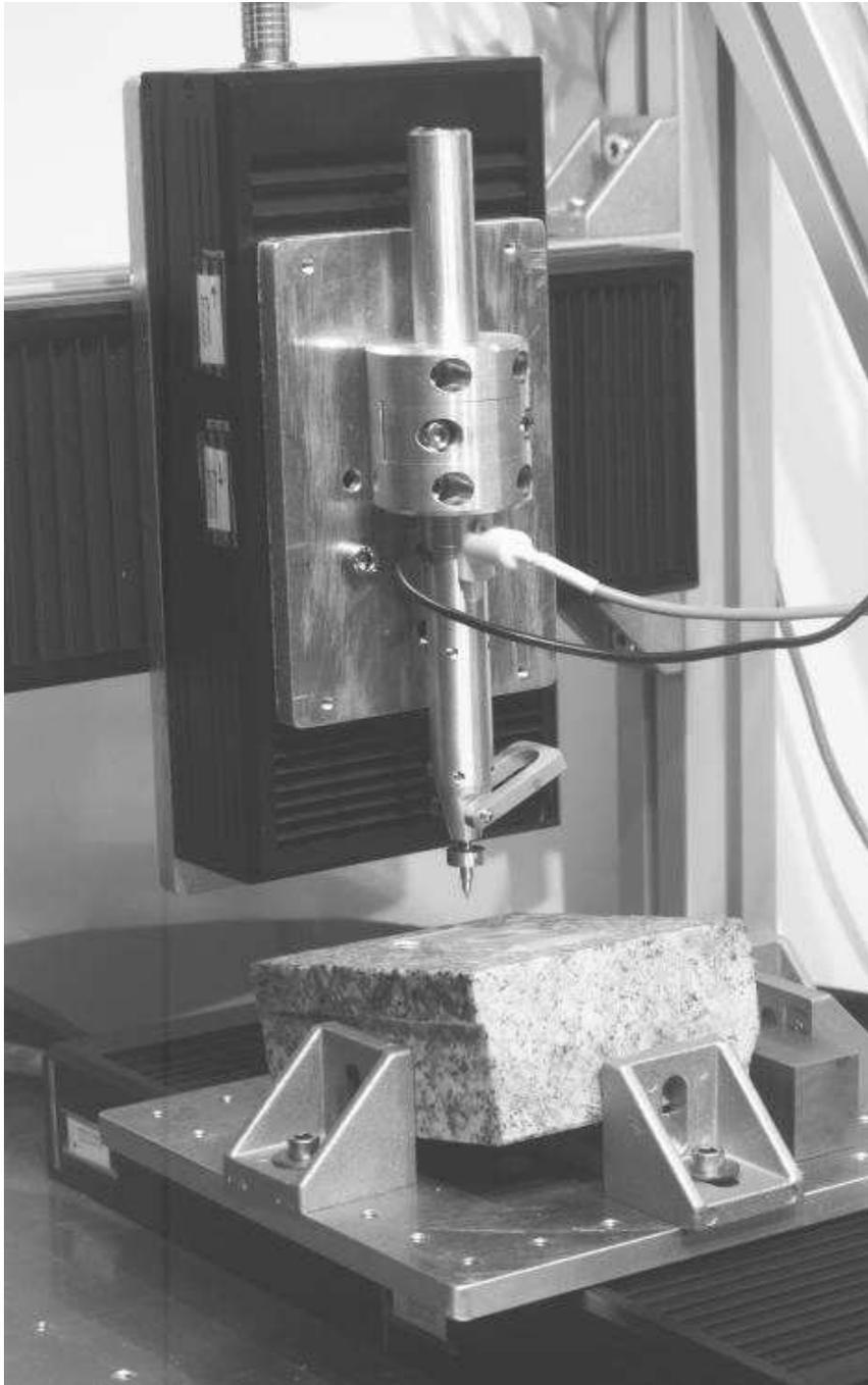
(a) Système de mesure mécanique. Un support en aluminium est fixé sur la table à déplacement  $z$ . Il contient le capteur LVDT, dont l'équipage mobile muni d'une pointe dépasse en-dessous, à la verticale du point dont on cherche à déterminer l'altitude.
