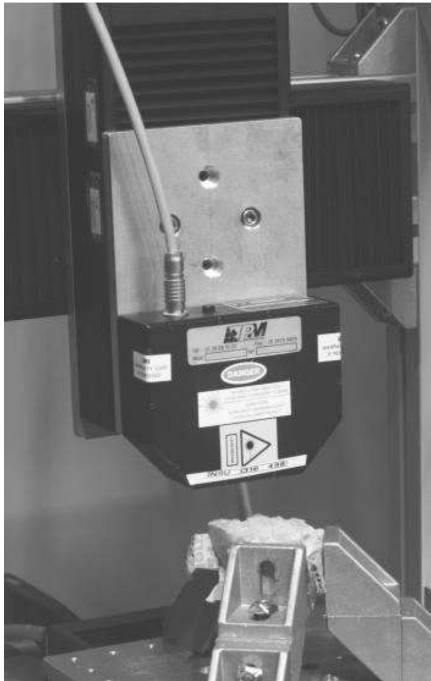
(b) Système de mesure optique. Le capteur optique lit la distance qui le sépare du point de la surface situé en-dessous de lui, à sa verticale. Il est solidaire de la table à déplacement z .
