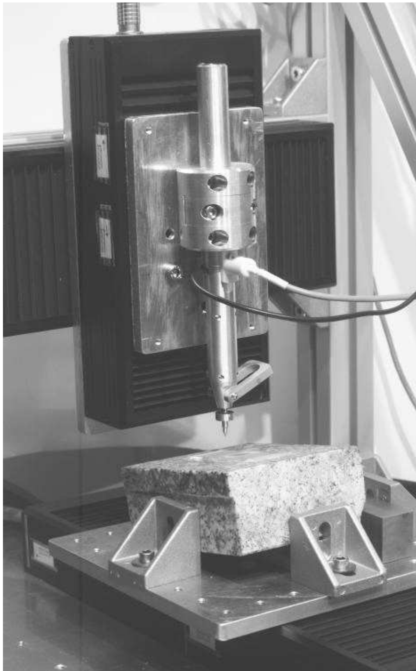
(a) Système de mesure mécanique. Un support en aluminium est fixé sur la table à déplacement z . Il contient le capteur LVDT, dont l'équipage mobile muni d'une pointe dépasse en-dessous, à la verticale du point dont on cherche à déterminer l'altitude.
