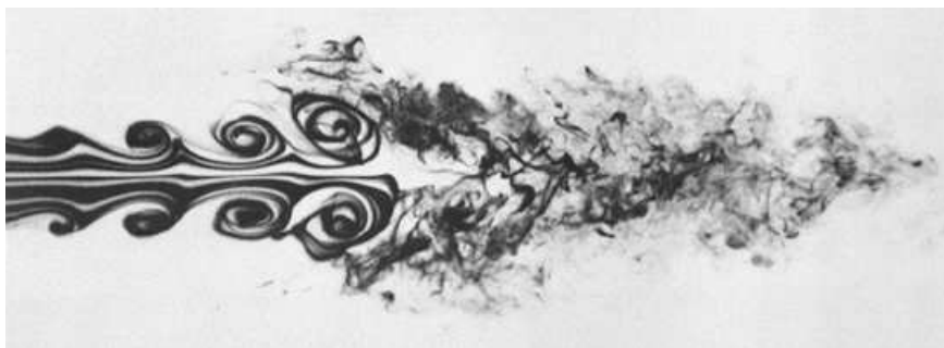
FIG. III.1 – Illustration de la transition laminaire-turbulent. Un jet d'air issu d'un cylindre d'ouverture circulaire s'écoule de la gauche vers la droite avec un nombre de Reynolds de l'ordre de 10000 (voir le III.2.c) et est rendu visible par l'injection de fumée. On voit la fin, à l'extrême gauche, du régime laminaire, puis le développement d'instabilités, de tourbillons formant une double allée de Bénard et von Kármán, puis l'installation abrupte du régime turbulent, à droite. Image issue de [van Dyke, 1982].
