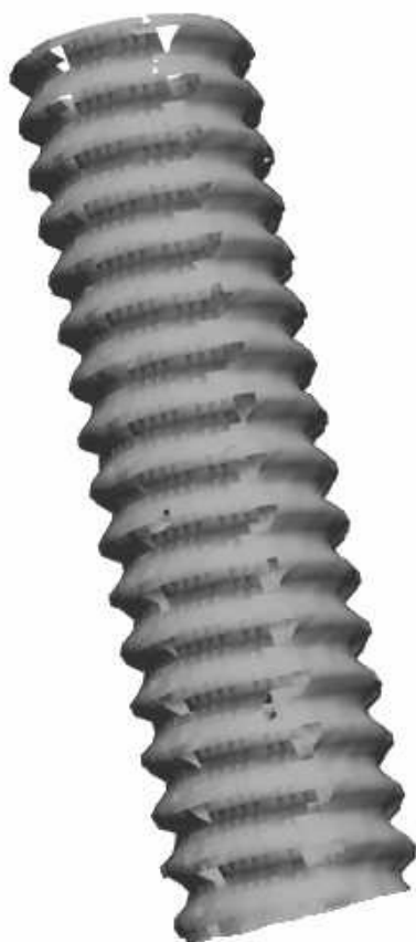
Figure 3-43. Exemple de mesure de relief 3D total sur une vis sans fin.
