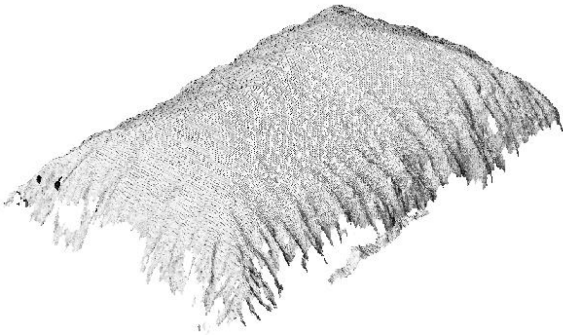
Figure 3-25. Relief représenté par des facettes (DXF) obtenu avec la technique hétérodyne de Morimoto à 8 images.
