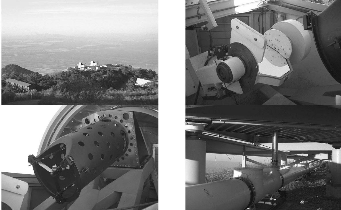
FIG. I.3.1 – Site IOTA : vue d'ensemble, sidérostats, télescope et cuve à vide.
