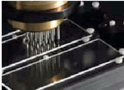
Figure A.2.3 Vue rapprochée des aiguilles d'un robot de dépôt.
