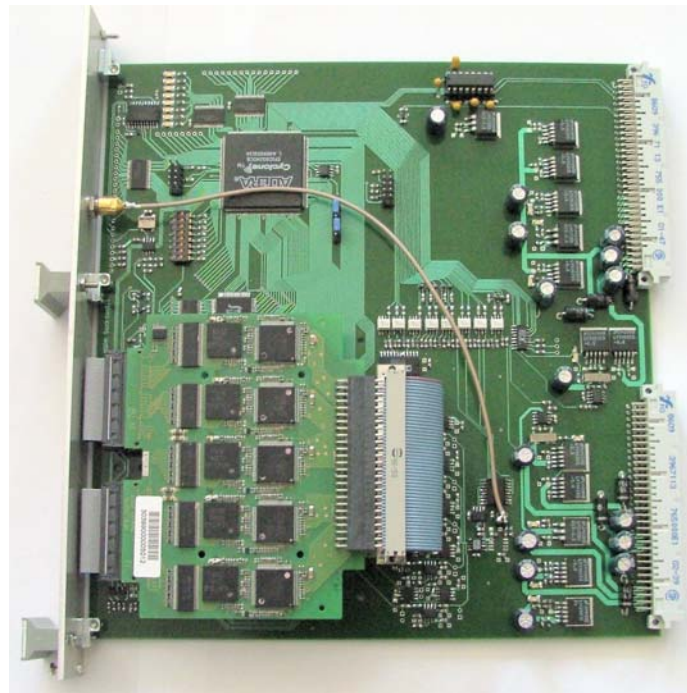
Fig. III.87 – Carte d'étalonnage des circuits électroniques frontaux, développée à l'Institut de Physique Nucléaire de Lyon.
