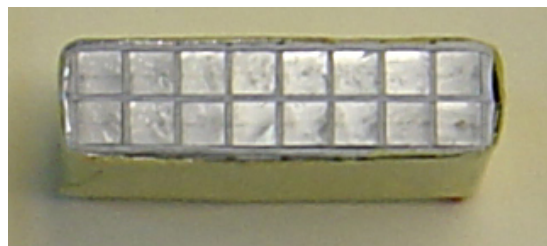
Fig. IV.10 - Bloc de 16 cristaux placés dans un panier de tyvek/aluminium. Chaque cristal présente une face de 2 \times 2 \text{ mm}^2 .
