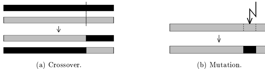
Figure 3.10: Exemple d'opérateur de recombinaison (crossover) et de mutation.
