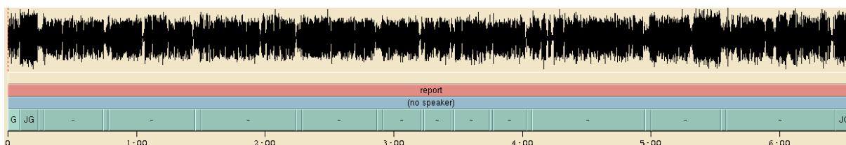
FIG. 7.5 – Détection automatique de jingles sur le « 6 minutes » de M6 avec « G » pour « Générique », « JG » pour « jingle_M6_generique » et « J » pour « jingle_M6 » (petits intervalles).
