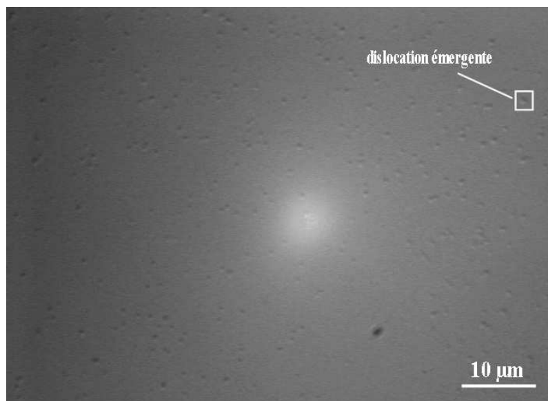
FIG. 1.24: Exemple de révélation des dislocations émergentes pour l'échantillon centre (3) (microscope optique).
