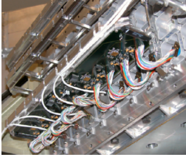
FIG. 2.15: Photographie de la carte EIB. Une carte EIB est liée à un ensemble de 9 photomultiplicateurs.
