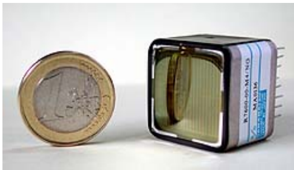
FIG. 1.29: Photographie d'un photomultiplicateur ( 2.57 \times 2.57 \text{ cm}^2 ) 4-anodes du calorimètre.
