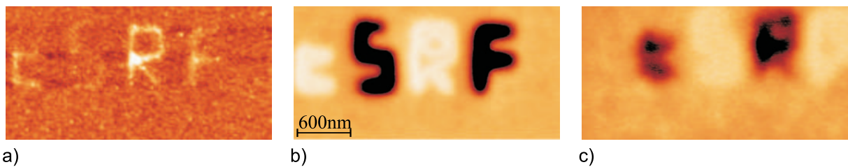
FIG. 4.15: Stabilité de la charge dans l'échantillon E3. Le sigle "ESRF" a été "écrit" avec des charges, en polarisant la pointe alternativement à -6\text{ V} et +6\text{ V} . a) Image de topographie de 1,5 \times 3\ \mu\text{m}^2 . Les charges apparaissent comme une hauteur apparente. b) : Image EFM effectuée en polarisant la pointe à -2\text{ V} . La polarité des charges est mise en valeur : contraste clair pour les électrons, contraste sombre pour les trous. c) : Image EFM effectuée 4 heures après injection. La pointe est polarisée à +1\text{ V} . Le sigle est toujours bien lisible, les nuages d'électrons ne sont pas étalés mais seulement estompés.
