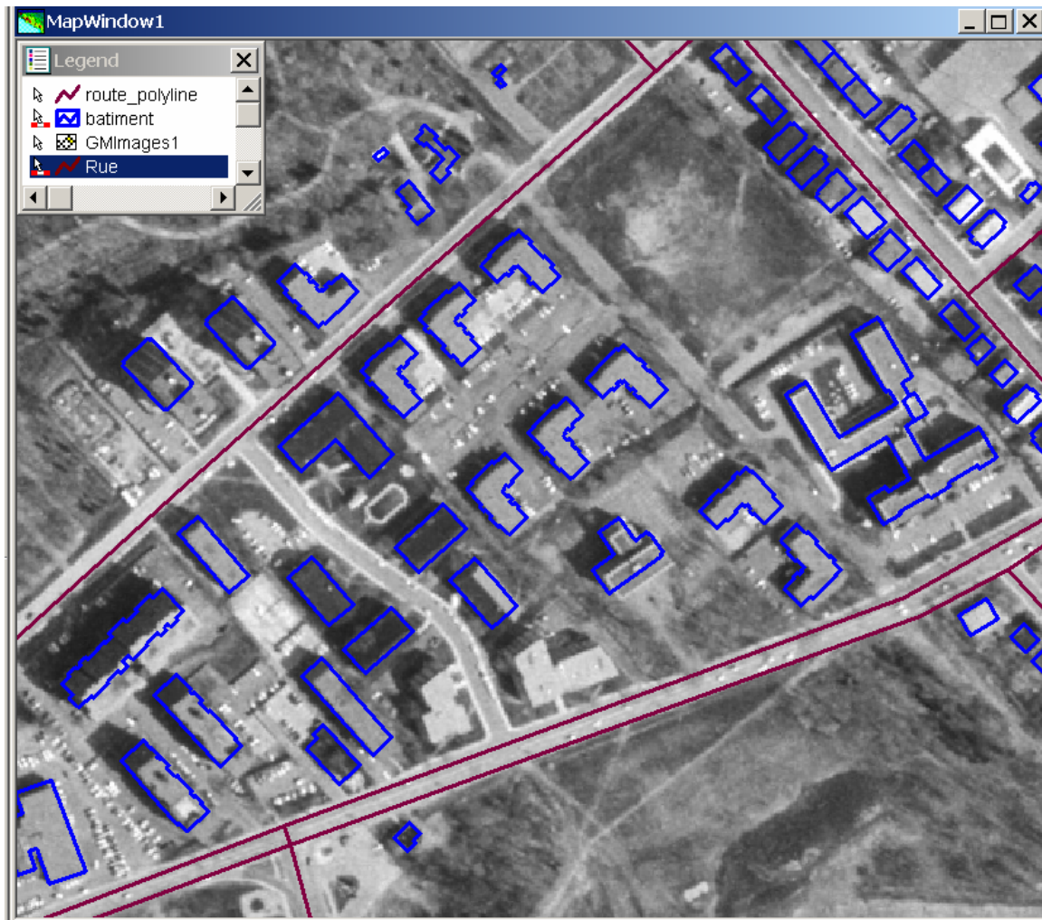
Figure n°9. Exemple d'incohérence résultant de l'intégration d'une photographie aérienne et d'une carte numérique
