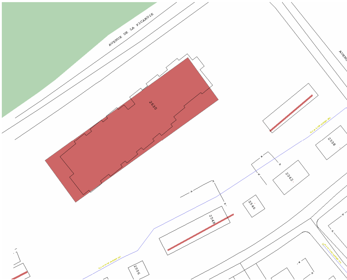
Figure n°8. Exemple d'incohérence provoquée par la superposition de cartes différentes dont le géoréférencement est différent
