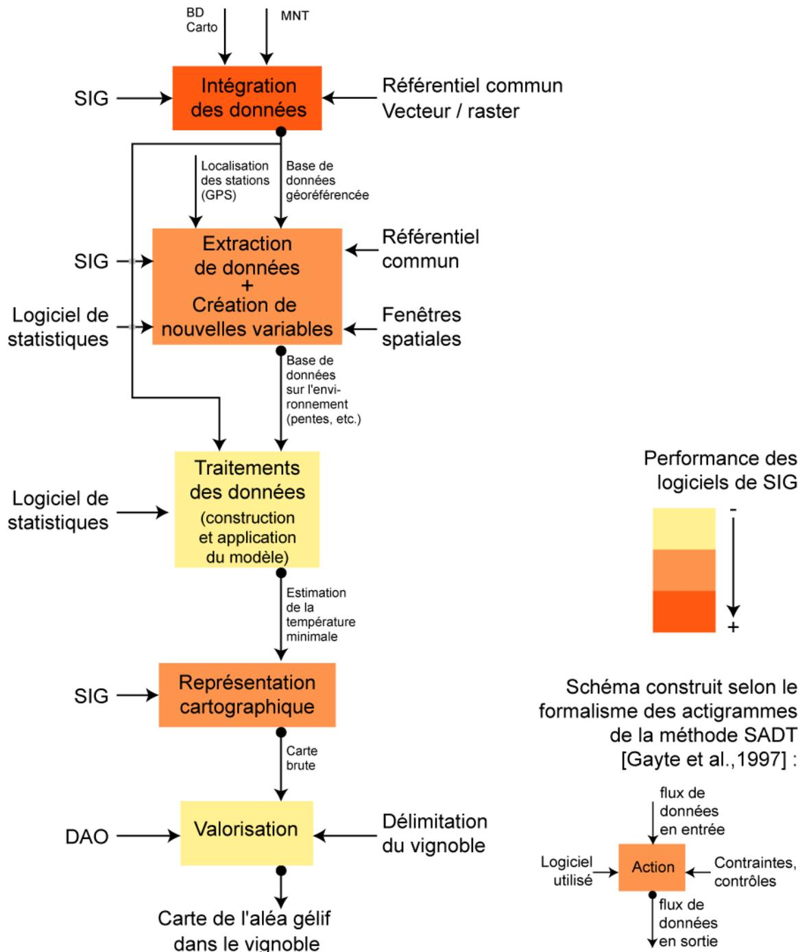
Figure VI.2 : Schéma illustrant la place des logiciels Sig dans notre chaîne méthodologique
