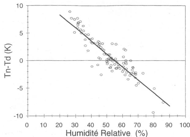
Figure II.12 : Relation entre l'humidité relative au coucher du soleil et l'écart entre la température minimale observée ( $T_n$ ) et le point de rosée ( $T_d$ ) au coucher du soleil
