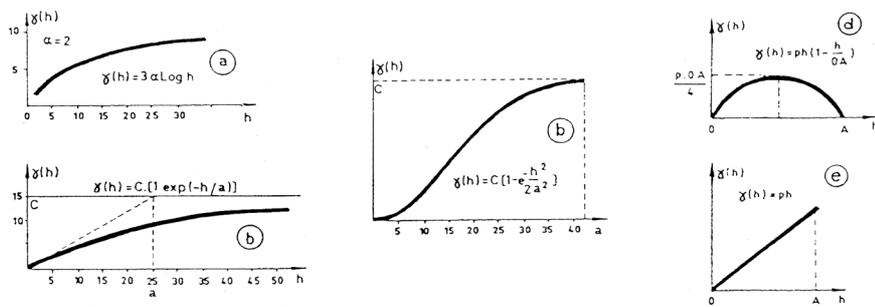
Figure XIII.6 : Quelques modèles d'ajustement possibles des variogrammes
