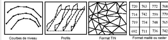
Figure V.1 : Différents formats d'un modèle numérique d'élévation
