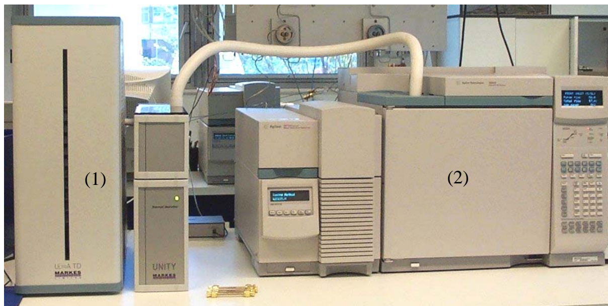
Photo 2 : couplage TD/CG/SM (1 – thermodésorbteur équipé d'un passeur automatique de 100 tubes UTRA™-UNITY™ Markes; 2 - couplage chromatographe en phase gazeuse 6890/spectromètre de masse 5973 Agilent)
