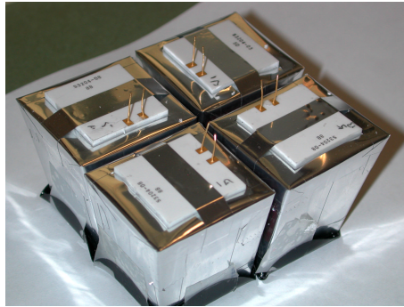
FIG. 5.8 – Les quatre cristaux CsI(Tl) prototypes munis de leurs photodiodes.
