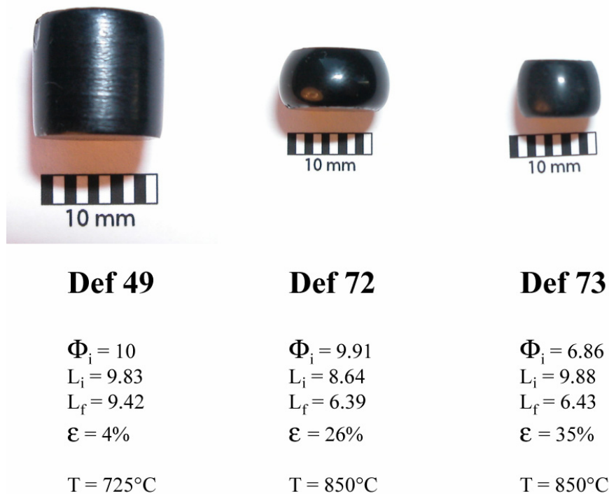
Figure IV - 4: Cylindres d'Eburru de différentes tailles déformés à 300 MPa à différentes températures durant 30 minutes.
