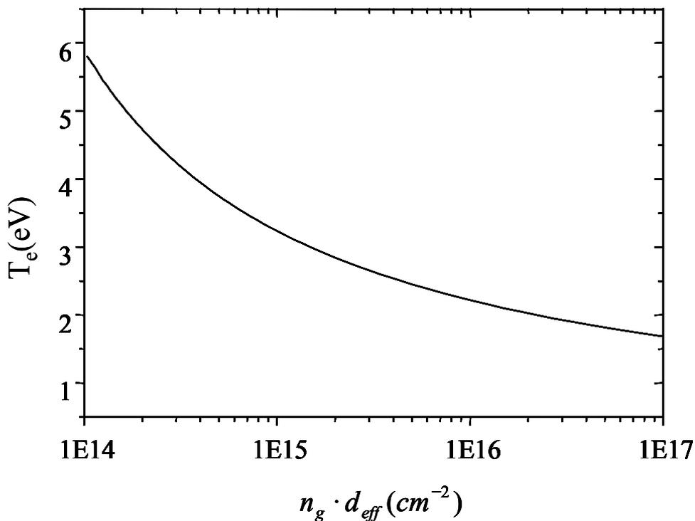
Fig. 1-7:  $T_e(n_g \cdot d_{eff})$  pour des électrons maxwelliens dans argon.<sup>66</sup>
