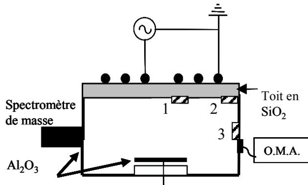
Fig. 3-5: Schéma du montage expérimental. Les numéros 1, 2 et 3 indiquent les positions où le taux net de dépôt de la couche SiO<sub>x</sub>Cl<sub>y</sub> a été mesuré (voir Tableau 3-2).
