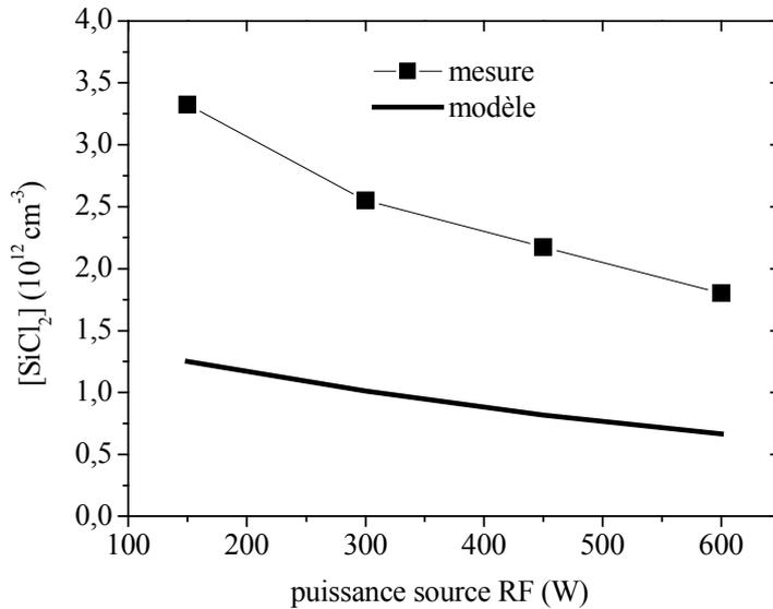
**Fig. 5-17:** Concentration de SiCl<sub>2</sub> mesurée et calculée en fonction de la puissance source.
