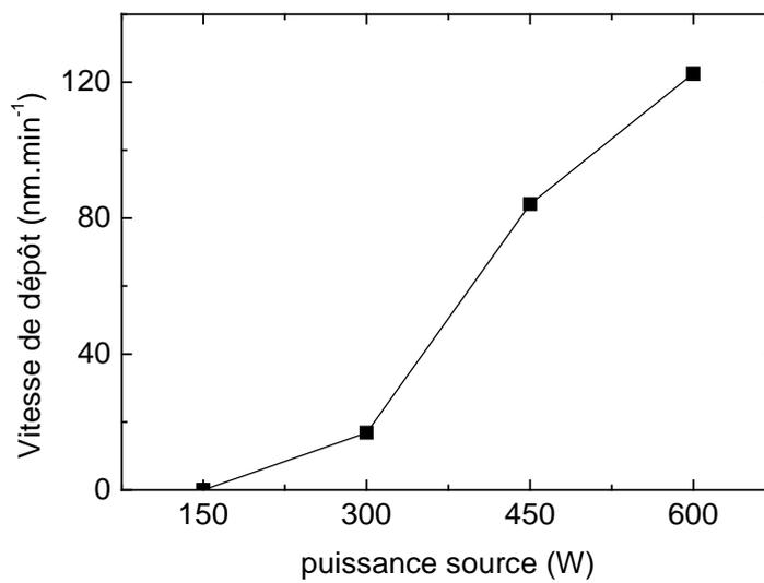
**Fig. 5-19:** Taux de dépôt de la couche SiO<sub>x</sub>Cl<sub>y</sub> sur les parois du réacteur calculé à partir de la différence du flux incident de Si sur les parois et le flux de SiCl<sub>2</sub> produit sur la surface.
