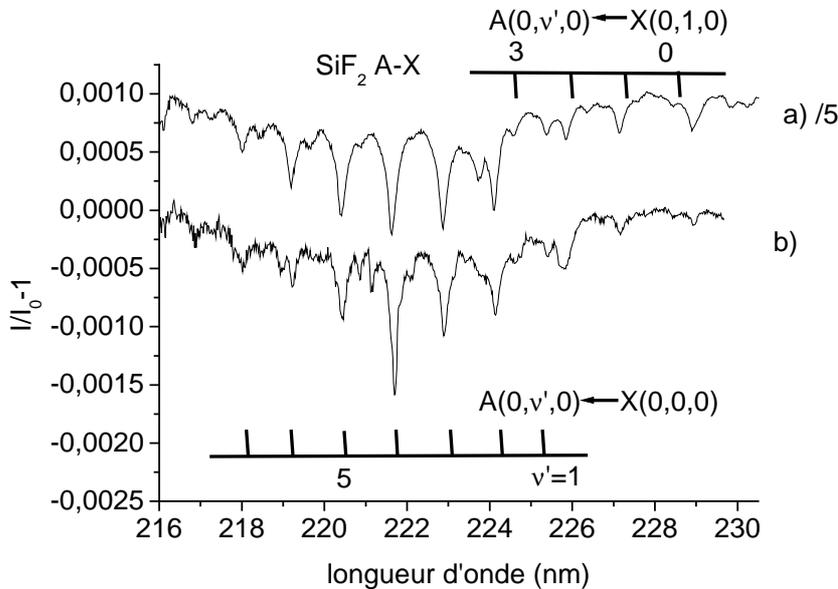
**Fig. 4-8:** Transition  $\tilde{A}^1B_1 - \tilde{X}^1A_1$  de SiF<sub>2</sub> pendant la gravure du silicium avec a) un plasma de CF<sub>4</sub> pur (plasma 7 du Tableau 4-1), divisé par 5 et translaté verticalement de  $10^{-3}$  et b) plasma 6 du Tableau 4-1.
