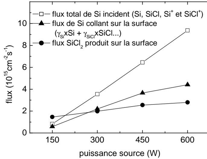
**Fig. 5-18:** Comparaison du flux de Si incident sur les parois, du flux de Si collant sur les parois et du flux de SiCl<sub>2</sub> quittant la surface.
