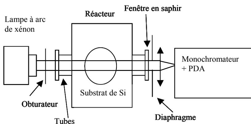
**Fig. 2-3:** Montage expérimental pour les expériences d'absorption.
