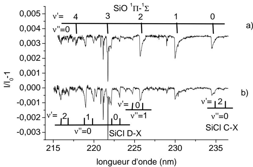
**Fig. 4-10:** Spectre d'absorption de SiO pendant la gravure du silicium avec un plasma HBr/Cl<sub>2</sub>/O<sub>2</sub> a) 20 sccm d'O<sub>2</sub> (plasma 9 du **Tableau 4-1**, translaté verticalement de 0,0035) et b) 5 sccm d'O<sub>2</sub> (plasma 1 du **Tableau 4-1**).
