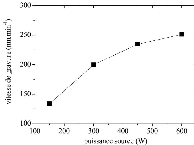
**Fig. 5-9:** Vitesse de gravure en fonction de la puissance source. Conditions: HBr (120 sccm) / Cl<sub>2</sub> (60 sccm) / O<sub>2</sub> (5 sccm), 5 mTorr.
