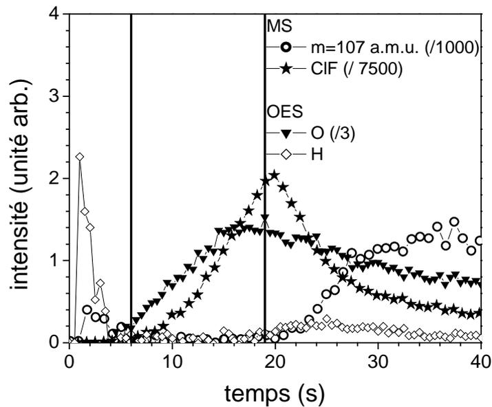
**Fig. 3-9:** Evolution temporelle de O, H, CIF et  $m=107$  amu (probablement  $\text{Al}_2\text{O}_2\text{FH}_2$ ) pendant la gravure de la couche avec un plasma  $\text{Ar}/\text{SF}_6$  (plasma 3 du Tableau 3-1). Les barres verticales indiquent approximativement les points de fin d'attaque pour l'élimination de la couche sous l'antenne et l'apparition des parois latérales en  $\text{Al}_2\text{O}_3$  de la chambre (respectivement 6 et 19 s).
