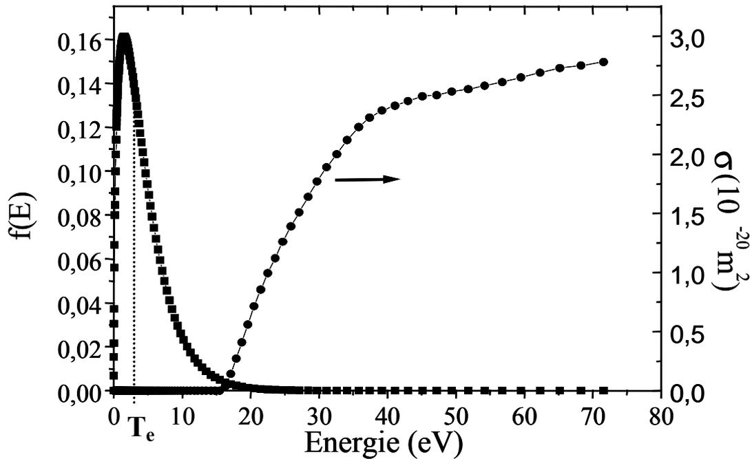
**Fig. 1-3:** Fonction de distribution de l'énergie des électrons (maxwellienne avec  $T_e=3$  eV) et section efficace d'ionisation de l'argon par impact électronique.<sup>6</sup>
