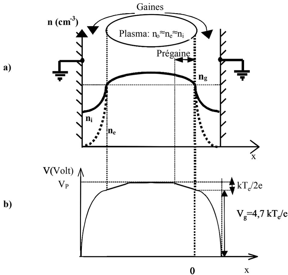
**Fig. 1-4:** Evolution qualitative de la densité électronique et ionique (a) et du potentiel (b) entre le centre du plasma et les parois du réacteur.
