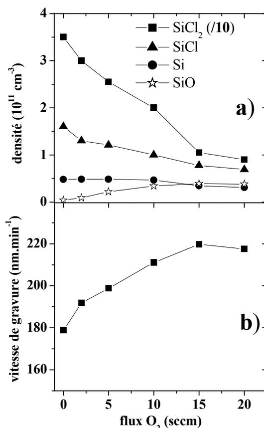
**Fig. 5-4:** a) Influence du flux d' $O_2$  sur les concentrations absolues de produits de gravure  $SiCl_x$  et  $SiO$  dans un plasma  $HBr$  (120 sccm)/ $Cl_2$  (60 sccm)/ $O_2$  (X sccm) à 5 mTorr, 300 W puissance source, 90 W puissance d'autopolarisation. La densité de  $SiCl_2$  a été divisée par 10. b) Vitesse de gravure du silicium dans les mêmes conditions.
