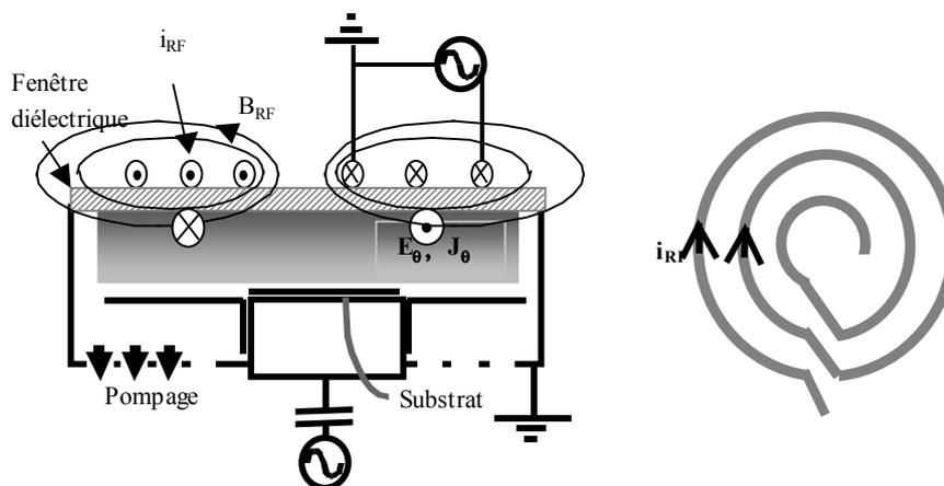
**Fig. 1-5:** Réacteur ICP: le courant  $i_{RF}$  circulant dans une antenne induit un champ électromagnétique E (et une densité de courant J) azimutal dans le plasma. A droite, le schéma de l'antenne vue de dessus.
