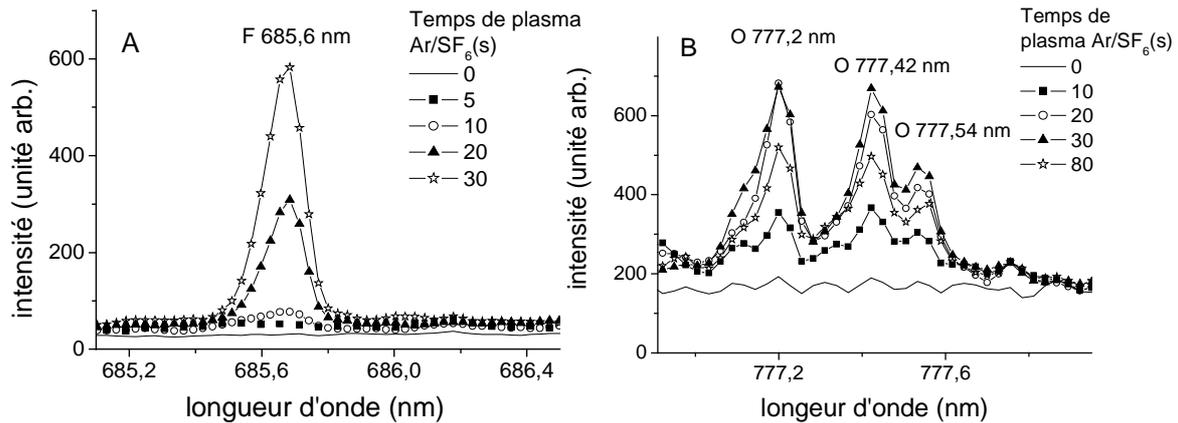
**Fig. 3-4:** Spectre d'émission en fonction du temps autour de 685 nm (A) et 777 nm (B) dans un plasma d'Ar/SF<sub>6</sub>.
