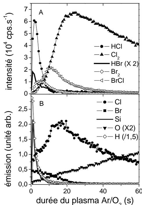
**Fig. 3-13:** Evolution temporelle de la concentration en phase gazeuse de plusieurs espèces pendant l'exposition de la couche  $\text{SiO}_x\text{Cl}_y$  à un plasma  $\text{Ar}/\text{O}_2$  (plasma 5, Tableau 3-1).
