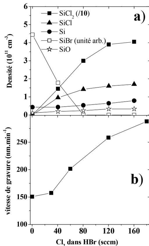
**Fig. 5-1:** a) Influence du flux de Cl<sub>2</sub> sur les concentrations de SiCl<sub>x</sub>, SiBr, et SiO. Conditions: HBr (X scms) / Cl<sub>2</sub> (Y scms) / O<sub>2</sub> (5 scms), (X+Y=160 scms), p=5 mTorr, 300 W puissance source et 90 W puissance d'autopolarisation. b) Vitesse de gravure du substrat de silicium dans les mêmes conditions.
