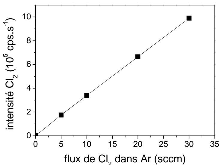
**Fig. 3-12:** Variation du signal  $\text{Cl}_2$  à 70 amu en fonction du flux de  $\text{Cl}_2$  dans le réacteur avec 50 sccm d'Ar à une pression totale de 15 mTorr.
