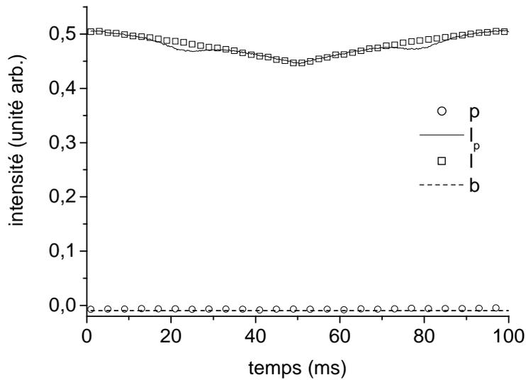
**Fig. 2-8:** Allure des quatre signaux p (plasma sans laser),  $I_p$  (plasma et le faisceau laser présents), I (laser sans plasma) et b (sans plasma ni le faisceau laser) dans un plasma HBr(120 sccm)/Cl<sub>2</sub>(60sccm)/O<sub>2</sub>(5 sccm)/Ar(10 sccm) à 5 mTorr, 450 W P<sub>s</sub> et 135 W P<sub>b</sub> dans une chambre passivée.
