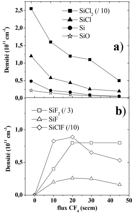
**Fig. 5-2:** Influence du flux de  $\text{CF}_4$  sur les concentrations absolues de produits de gravure a)  $\text{SiCl}_x$  et  $\text{SiO}$  et b)  $\text{SiF}_x$  et  $\text{SiClF}$  (valeur relative). Conditions du plasma: 5 mTorr, HBr (120 sccm) /  $\text{Cl}_2$  (60 sccm) /  $\text{CF}_4$  (X sccm) /  $\text{O}_2$  (5 sccm) à 300 W puissance source et 90 W de puissance appliquée au substrat.
