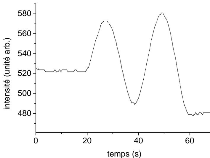
**Fig. 2-10:** Signal d'interférence obtenu pendant la gravure du Si dans un plasma HBr(120 sccm) / Cl<sub>2</sub>(60 sccm) / O<sub>2</sub>(10 sccm) à 5 mTorr, 300 W puissance source et 90 W puissance d'autopolarisation.
