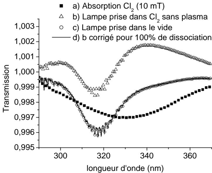
**Fig. 4-5:** Bande d'absorption de Cl<sub>2</sub> à 10 mTorr sans plasma (a), bande A-X de SiCl<sub>2</sub> pendant la gravure avec le plasma 3 du Tableau 4-1 avec L<sub>0</sub>(λ) pris avec gaz (10 mTorr Cl<sub>2</sub>) (b) et dans le vide (c). (d) a été obtenu en corrigeant (b) en considérant 100% de dissociation de Cl<sub>2</sub>.
