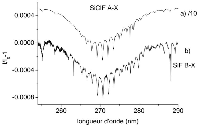
**Fig. 4-9:** Spectre d'absorption attribué à la transition SiCIF  $\tilde{A}^1B_1 - \tilde{X}^1A_1$  enregistré pendant la gravure du silicium avec a) plasma Cl<sub>2</sub>/CF<sub>4</sub> (plasma 8 du **Tableau 4-1**) divisé par 10 et translaté verticalement de  $5 \times 10^{-4}$  et b) plasma 6 du **Tableau 4-1**.
