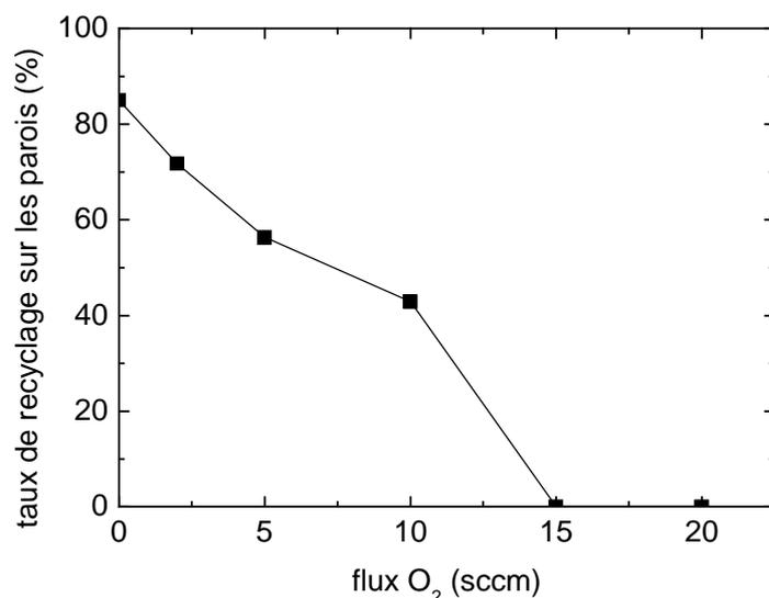
**Fig. 5-7:** Pourcentage du flux de Si,  $\text{Si}^+$ , SiCl et  $\text{SiCl}^+$  recyclé sur les parois pour former la quantité de  $\text{SiCl}_2$  calculé à partir de la production maximale possible et la production nécessaire de la Fig. 5-6.
