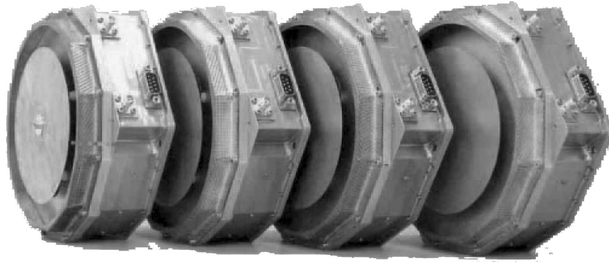
FIG. 3.2 – Light weight Cost-Effective Front-end deuxième génération : LICEF-2, développé par les sociétés MIER et EADS-CASA (Espagne). Ce dispositif intègre l'antenne et une chaîne de réception de type radiomètre de puissance totale.
