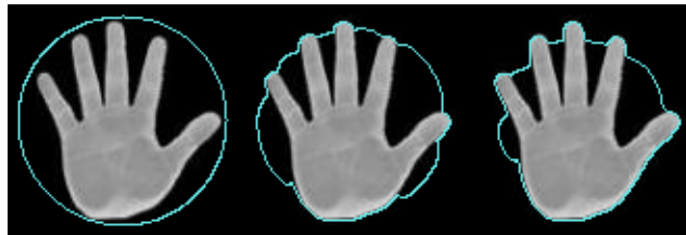
FIG. 19.12 – Représentation de la condition initiale, du niveau zéro de \Phi au temps t = 40 et au temps t = 80 .
