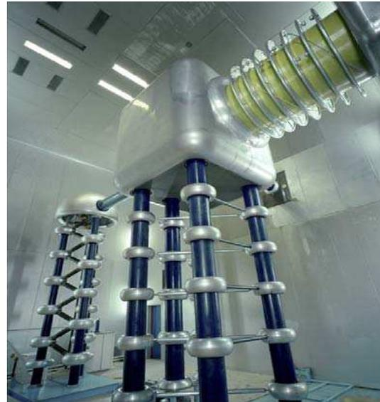
FIG. 1.3 – Des ions  $H^-$  sont produits à partir d'un gaz d'hydrogène ionisé (à gauche) et sont ensuite portés à une énergie de 750 keV par un accélérateur Cockcroft-Walton (à droite).
