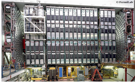
FIG. 1.26 – Photo du système de détections des muons. On aperçoit, à droite et à gauche, les scintillateurs et au centre les chambres à dérive.
