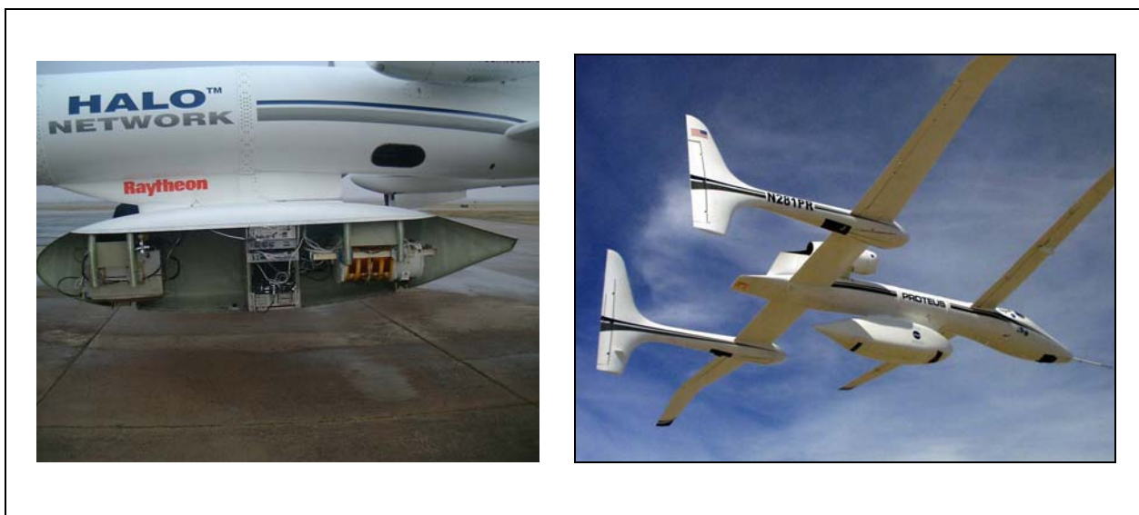
Figure IV.25 : Instrument NAST embarqué sous avion de type Proteus
