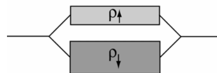
Fig.Intro.2 : Modèle de Mott : les électrons empruntent un canal de conduction différent selon leur spin. Chaque canal a sa propre résistivité et l'ensemble se comporte comme deux résistances en parallèle.
