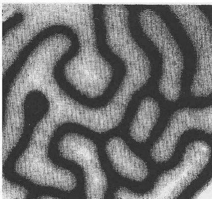
FIG. 1.3 – *Structure labyrinthe stationnaire observée dans la réaction FIS [20]. Les zones claire et foncée correspondent respectivement aux pH fort et faible.*
