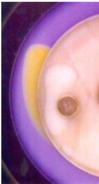
FIG. 3.7 – Onde d’excitabilité dans un réacteur anneau. Le front acide (en clair) se propage dans l’état flux asymptotiquement stable, le long du bord imperméable intérieur. Les conditions expérimentales sont :  $l_{\text{gel}} \text{ d'agarose } 2\% = 3\text{mm}$ ,  $[\text{NaClO}_2]_0 = 1,9 \cdot 10^{-2} \text{M}$ ,  $[\text{K}_2\text{S}_4\text{O}_6]_0 = 0,5 \cdot 10^{-2} \text{M}$ ,  $[\text{HClO}_4]_0 = 3,21 \cdot 10^{-3} \text{M}$ ,  $[\text{NaOH}]_0 = 1,73 \cdot 10^{-2} \text{M}$  [47].
