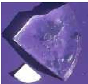
FIG. 5.3 – Cliché à température ( $T \geq \text{LCST}_{\text{gel}}$ ) de deux morceaux d'un même gel de poly(NIPAAm-co-AAc) ; l'un est acide, effondré et turbide (en bas à gauche), l'autre est basique, gonflé et clair. Cette situation prévaut tant que la proportion d'AAc dans le gel n'est pas trop élevée.
