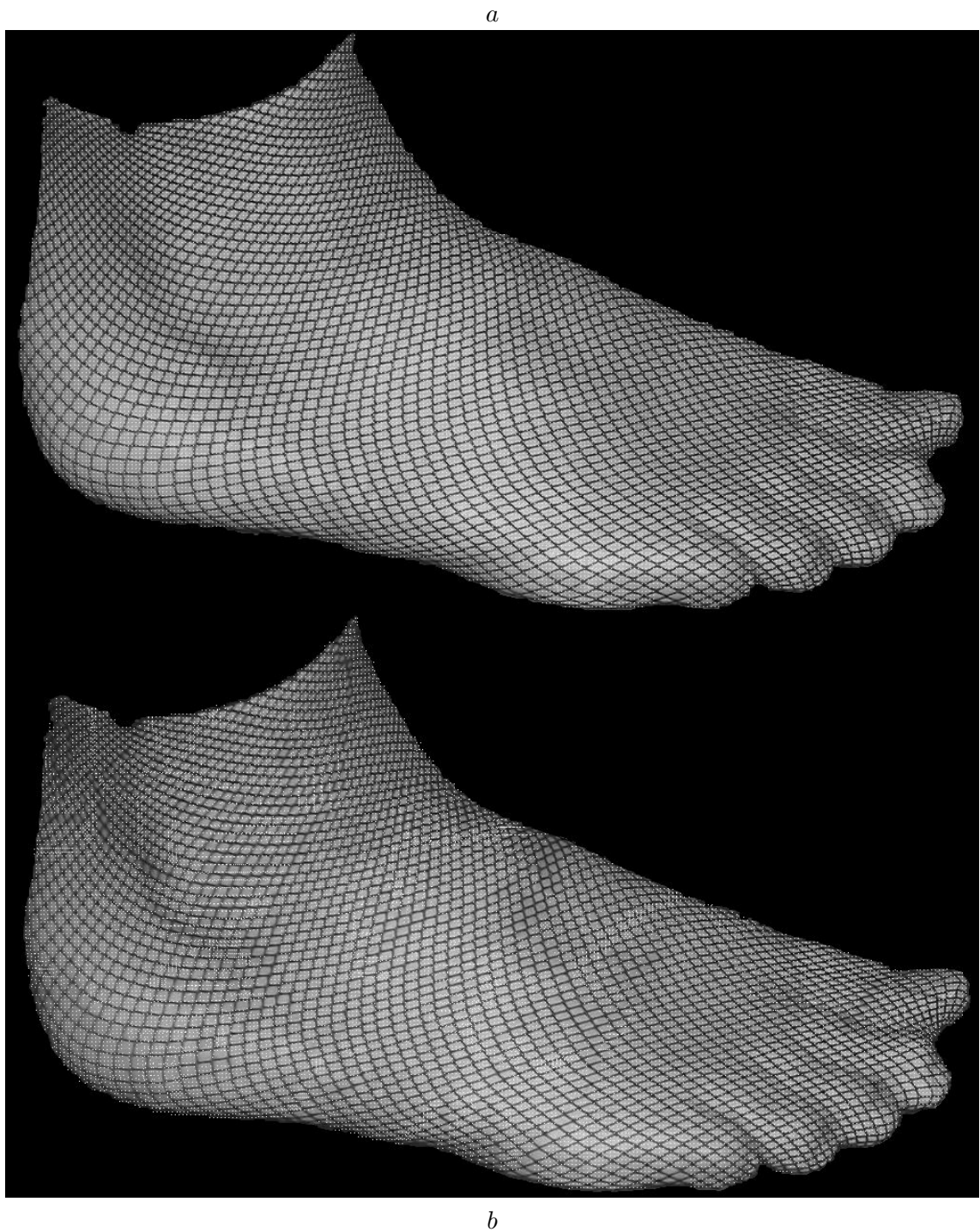
Figure 6.45 – Mise en correspondance avec réduction de la zone de recherche par la géométrie épipolaire, a : image de gauche, b : image de droite.
