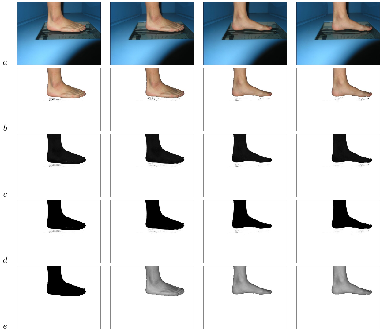
Figure 5.42 – a : images originales, b : images résultat du traitement spécifique dans RVB , c : la composante Teinte , d : la composante Teinte seuillée et e : images segmentées.
