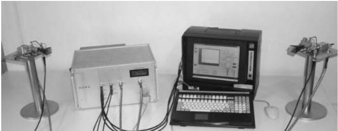
FIG. 4.2: Photo du système de mesure (sondeur de canal, ordinateur, têtes RF, antennes, câbles)
