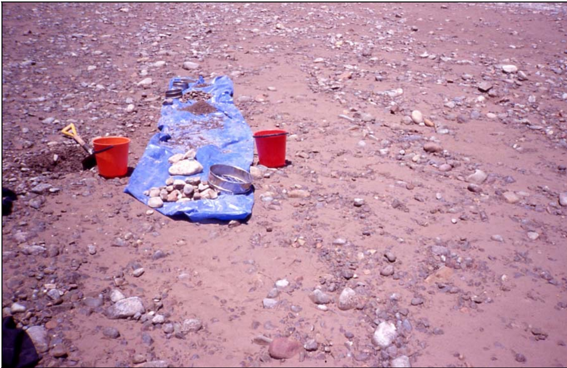
Figure III.24 : Echantillonnage des galets sur la rivière Pilcomayo
