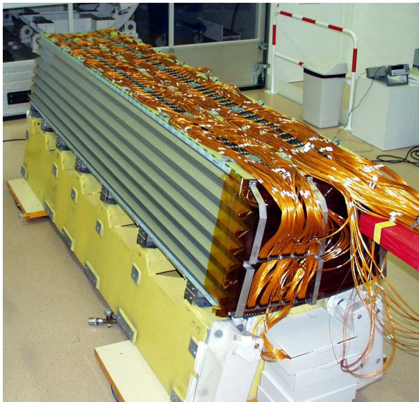
FIG. 3.26 – Photographie d'un module d'absorbeur de la partie tonneau, avec les câbles (jusqu'au niveau Patch panel de la figure 3.25) permettant de se connecter aux câbles qui sortent du cryostat [4].
