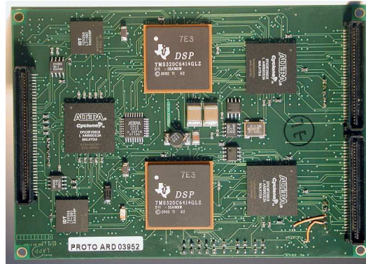
FIG. 3.36 – Synoptique (gauche) et photographie (droite) d'une unité de traitement PU (Processing Unit), permettant de traiter les données de 256 cellules en moins de 10 \mu s grâce à 2 DSP cadencés à 720 MHz [24].
