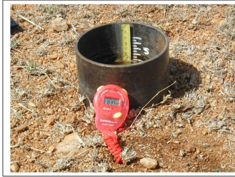
FIG. V.1: Essai d'infiltration avec l'infiltromètre à simple cylindre, ainsi que le chronomètre.
