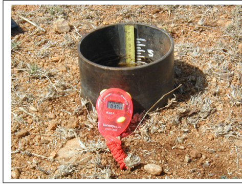
FIG. V.1: Essai d'infiltration avec l'infiltromètre à simple cylindre, ainsi que le chronomètre.
