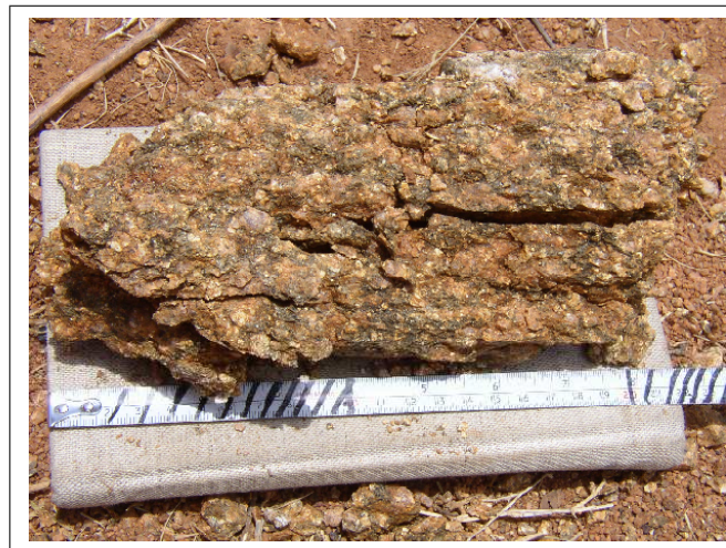
FIG. III.8: Exemple de motte de shapa marrum prélevée à 170 cm dans la fosse du site 26.
