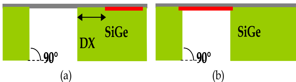
Figure 79 : gravure DRIE du substrat silicium à (a) : \Delta X = 50 \mu\text{m} , (b) : \Delta X = 50 \mu\text{m} , en dessous du TBH testé.
