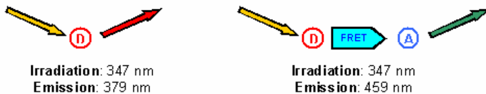
Figure 41: Représentation schématique de l'irradiation d'un donneur (D) seul et de son émission (à gauche) et de l'irradiation du couple accepteur (A) / donneur (D) mettant en jeu le phénomène de FRET avec émission de l'accepteur (à droite). Les couleurs sont utilisées à titre indicatif. Les longueurs d'onde mentionnées sont celles du couple pyrène (D) / pérylène (A) tel qu'il fut utilisé dans une expérience de FRET appliquée aux acides nucléiques [50]
