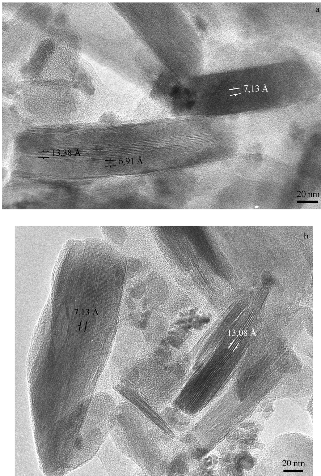
Figure 25 : Exemple de particules complexes observées en microscopie électronique à transmission dans un microagrégat inclu (PAT 2 150-160 cm) : a) en haut, particule de kaolinite rectangulaire sur la tranche dont la distance mesurée entre les feuillets est de 7,13 Å, en bas, particule rectangulaire hétérogène constituée au cœur par des feuillets distants de 13,38 Å et en périphérie par des feuillets distants de 6,91 Å, b) à gauche, particule de kaolinite pseudo-rectangulaire, à droite, particule hétérogène constituée au cœur par des feuillets distants de 13,08 Å et en périphérie par des feuillets distants de moins de 7 Å (Clichés C. Clinard).
