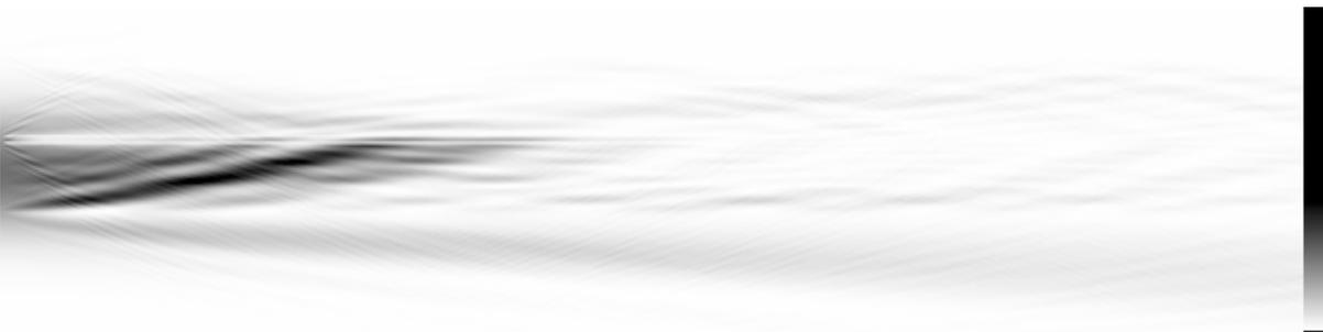
Figure III-1.22 : simulation de la propagation avec la fibre décalée de  $2,5 \mu m$  vers le substrat. La lentille continue de remplir sa fonction. Les pertes dans le substrat augmentent (rendement quantique = 87 %).
