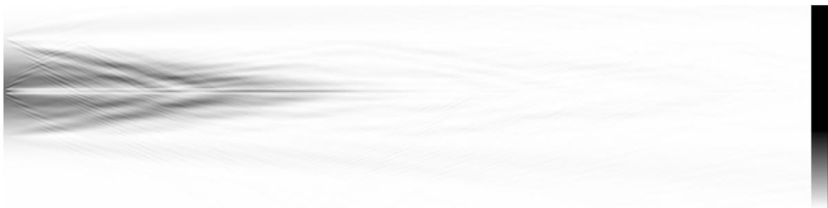
Figure III-1.21 : simulation de la propagation de la lumière sur  $100 \mu m$  dans une structure à coeur composite. On voit très bien l'effet de lentille. Le rendement quantique est de 96 %.
