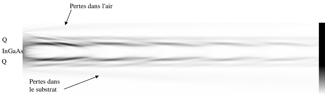
Figure III-1.10 : simulation de la propagation sur 100  $\mu\text{m}$  dans une structure symétrique à deux quaternaires et cœur absorbant de 3  $\mu\text{m}$ . On voit bien les pertes dans l'air et le substrat.  $\eta=89 \%$  à  $\lambda=1,55 \mu\text{m}$ .
