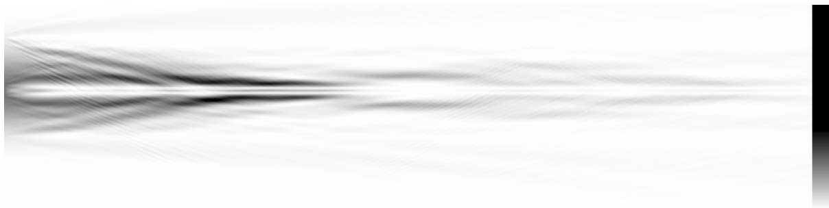
Figure III-1.19 : simulation de la propagation sur 100 \mu m dans une structure à quatre quaternaires d'épaisseurs optimisées. Coeur absorbant de 1 \mu m .
