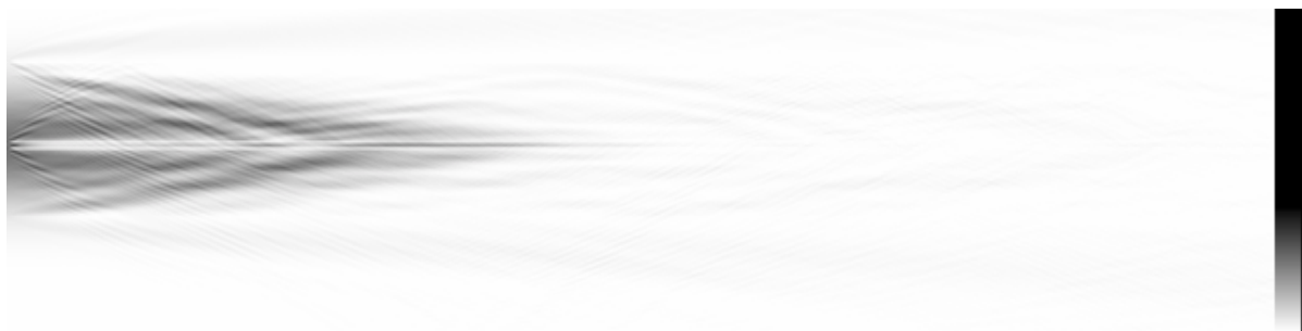
Figure III-1.21 : simulation de la propagation de la lumière sur 100 \mu m dans une structure à coeur composite. On voit très bien l'effet de lentille. Le rendement quantique est de 96 %.
