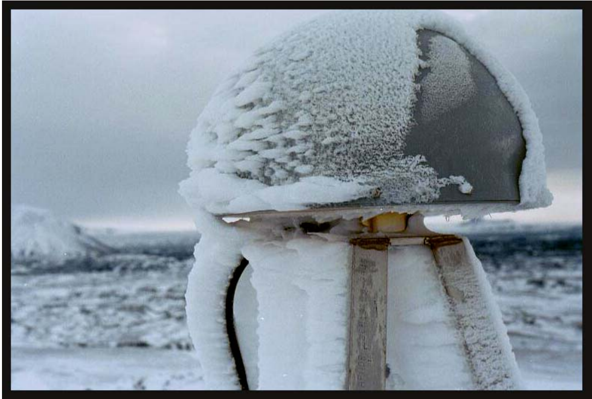
Figure III.13 : Photographie du radôme de la station SKRO en novembre 2000. Une couche importante de 5 à 10 cm de neige glacée s'est accumulée sur l'ensemble de la station ce qui peut perturber l'acquisition des mesures. Photographie de Halldor Geirsson [Veðurstofa, 2004].
