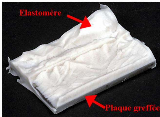
Photo II-37 - Plaque centrale greffée arrachée du RTV 573
