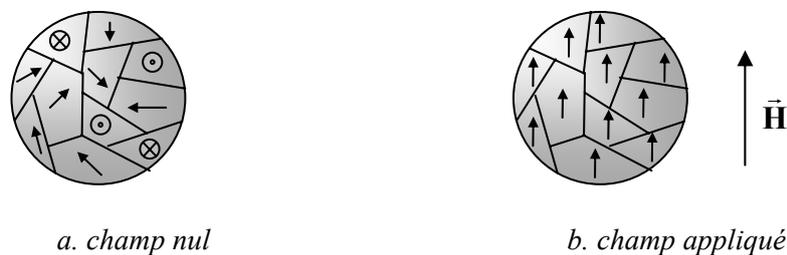
Figure V-23 - Comportement magnétiques des particules de fer ex-carbonyle
