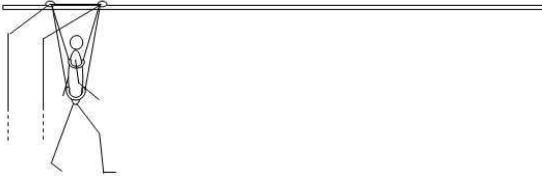
Figure V.3. : Harnais de suspension pour prévenir les éventuelles chutes
