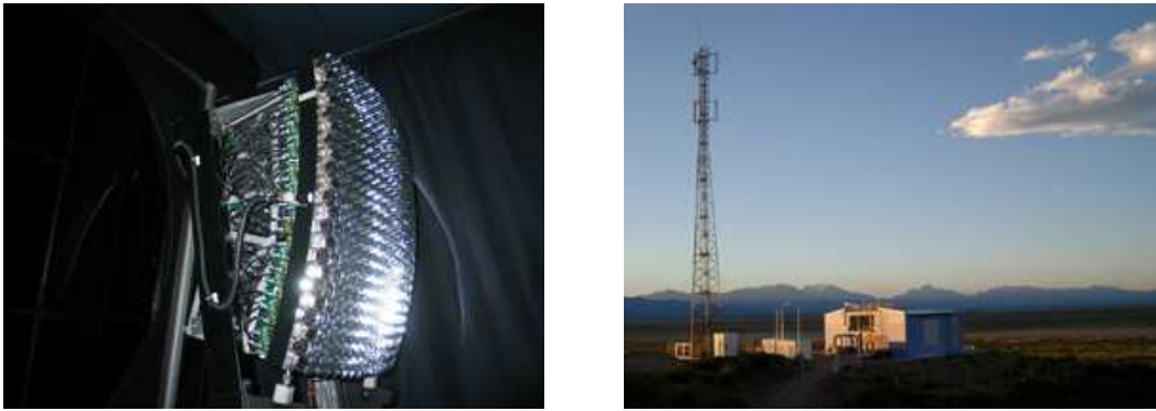
FIG. 2.8 – Gauche : photo de la caméra positionnée dans le plan focal du télescope ; Droite : photo du 1er bâtiment construit en 2002, Los-Leones, ainsi que l'antenne de communication associée
