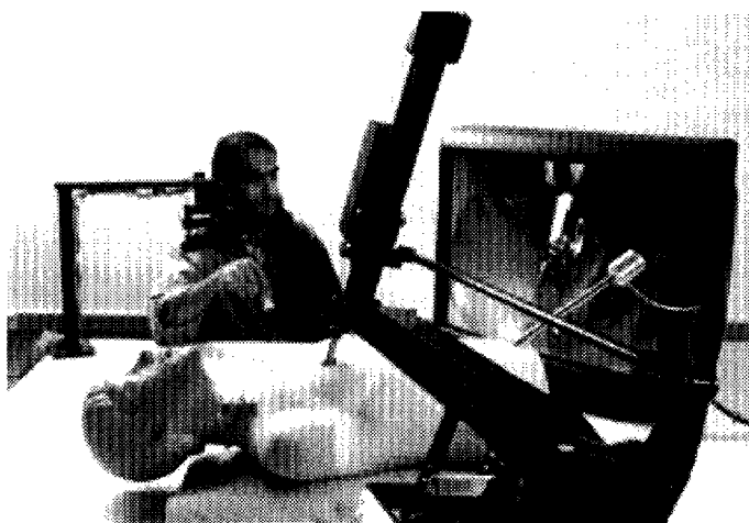
Figure 1-6 : Robot Black Falcon : Bras télémanipulé basé sur une architecture parallélogramme et un outil de 10mm orientable au moyen de câbles mécaniques (8 DLL).
