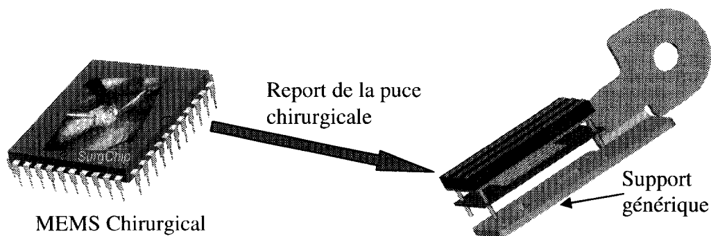
Figure 2-1: Intégration par report d'une puce chirurgicale sur un support générique
