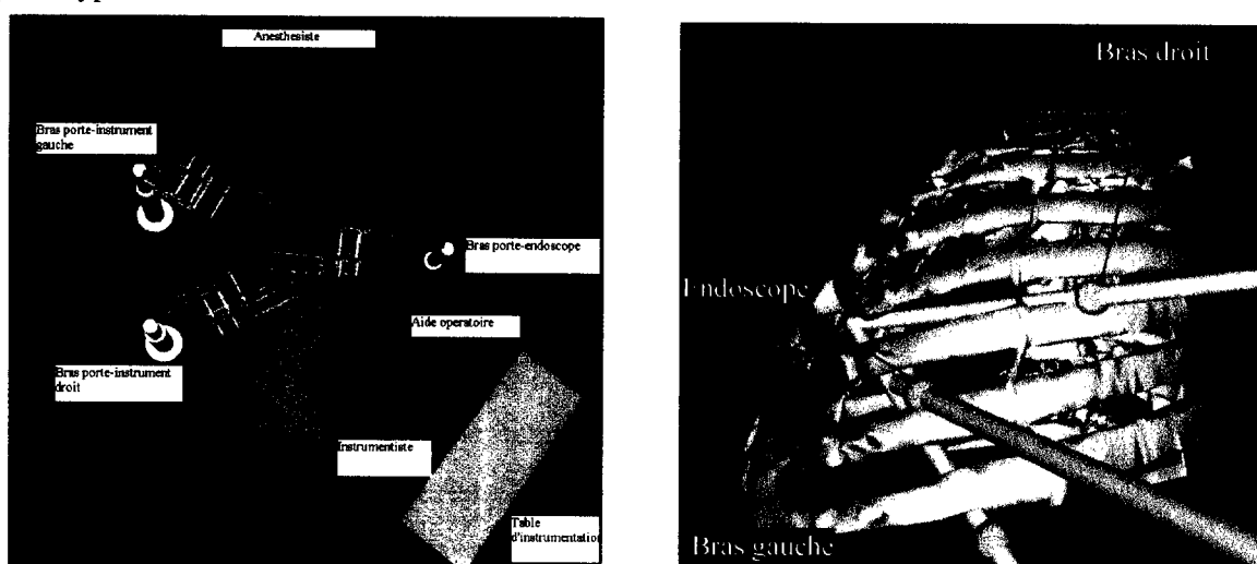
Figure 3-3 : Simulation du placement des bras maîtres EndoXiroB pour une application de chirurgie digestive et cardiaque, INRIA.
