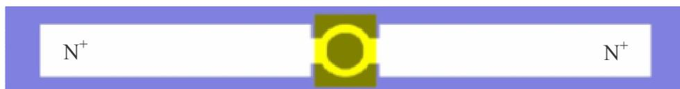
Figure III.19 : Résistance avec un masque d'activation rectangulaire (90\*108 $\mu\text{m}$ )
