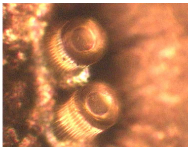
Figure III.30 : Photo au microscope optique du dessous de la buse non ouverte
