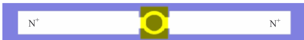
Figure III.19 : Résistance avec un masque d'activation rectangulaire (90*108μm)
