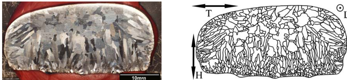
Figure III.6 : Micrographie de l'alliage FeAlNi4B (taille de grains > 500 \mu\text{m} )
