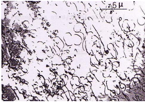
Figure I.15 : D'après [87]. Boucles a\langle 100 \rangle circulaires, dans l'alliage FeAl40 après trempe depuis 1150°C.
