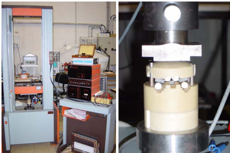
Figure II.6 : Machine de traction/compression permettant de faire, avec un montage approprié (photographie de droite), des essais de flexion quatre points.
