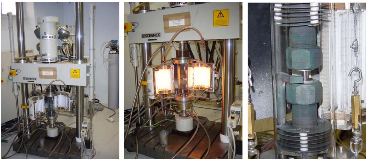
Figure II.3 : Machine de compression uniaxiale avec four à balayage d'argon.
