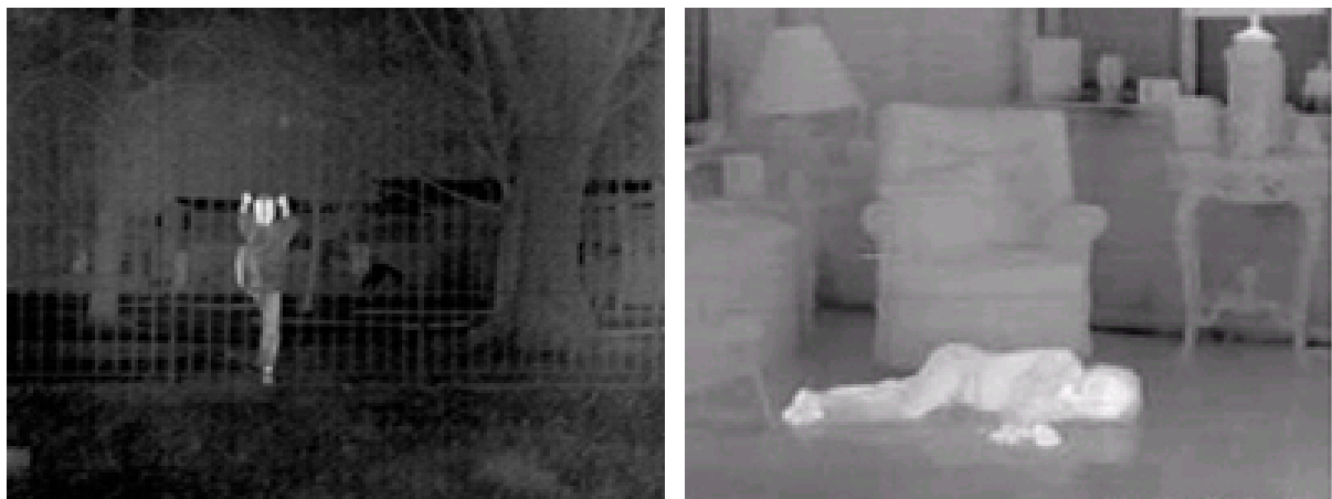
Figure 3 : Exemples d'images prises par des caméras IR utilisant un système non refroidi (d'après la société ULIS) 5 .
