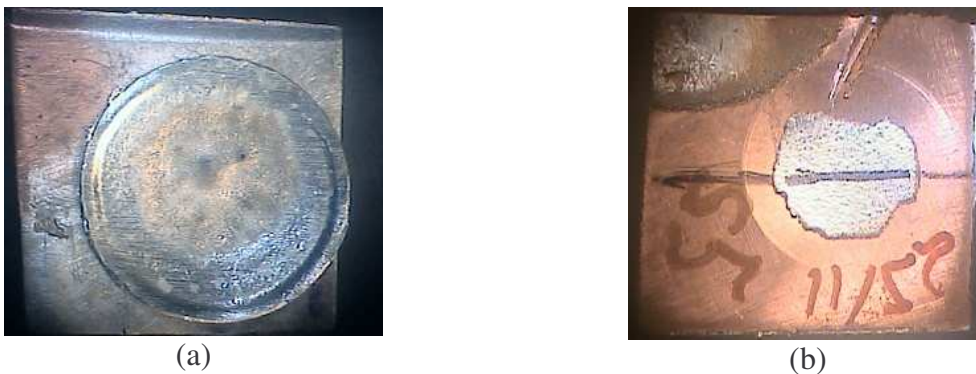
Figure B-15 Photographies d'une cible après le test F-LASAT (a) vue de la face supérieure, (b) vue de la face inférieure [1].
