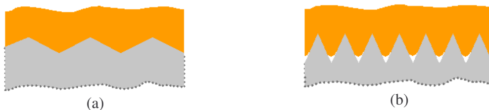
Figure VI-70 (a) Bon remplissage de la rugosité par la couche, (b) mauvais remplissage.
