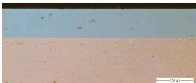
Figure I-5 Observation optique d'une couche de nickel déposée par procédé électrolytique sur un substrat de cuivre.
