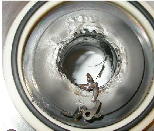
Fig3 : tape du four dans laquelle on incère le porte cible
