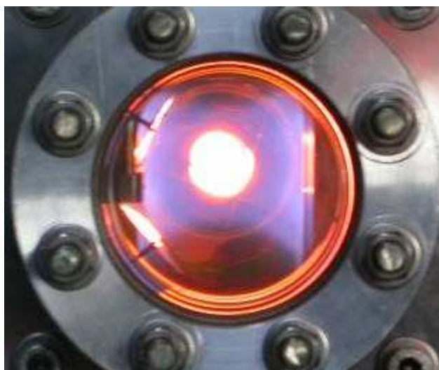
Cible chaude vue à travers le plasma de la source...
